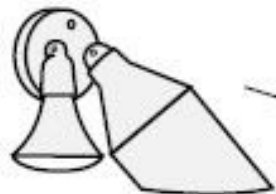
Properly-aimed PAR Floodlights
