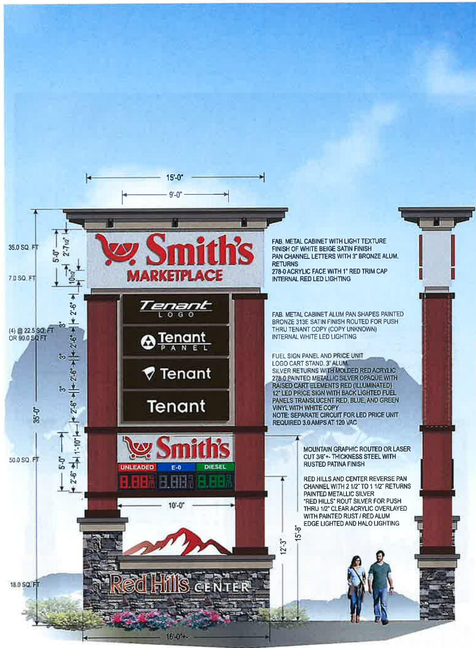
35 FT PYLON SIGN SCALE: 1/4"=1'-0"
