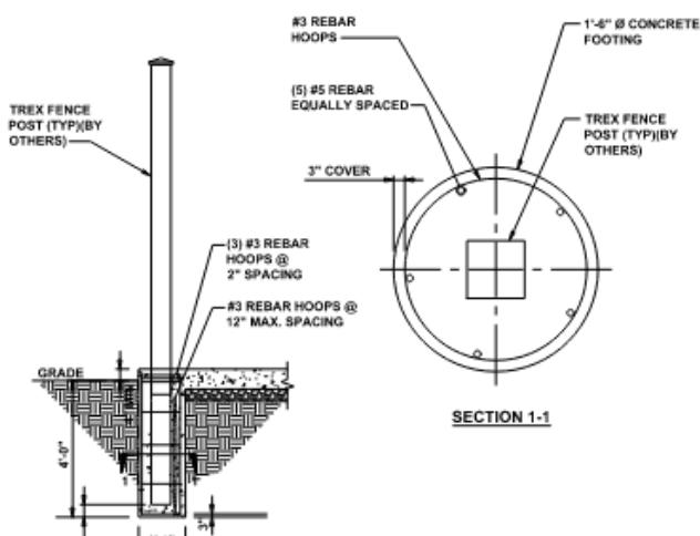
TYPICAL TREX FENCE ELEVATION
