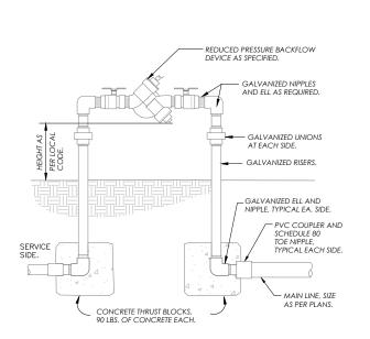
REDUCED PRESSURE BACKFLOW DEVICE D
